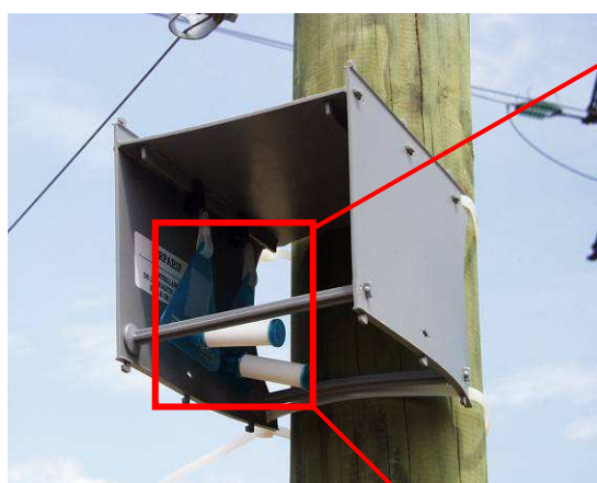
Figure 4 : Echantillonneurs passifs pour le benzène installés à l'intérieur de l'abri de protection.
